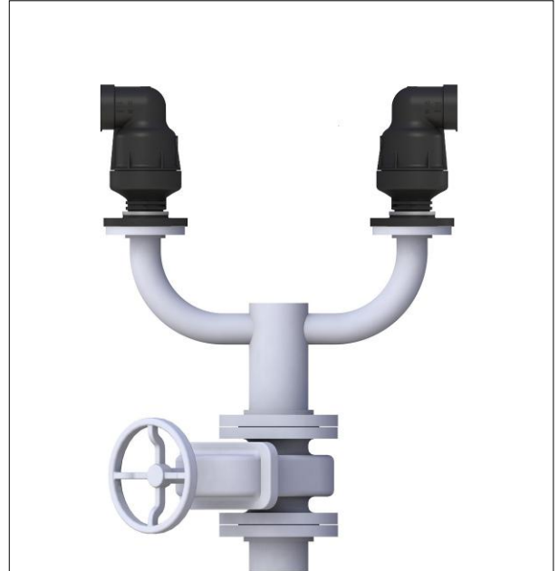
Dos válvulas de aire en una válvula de aislamiento compartida. Las salidas de la válvula de aire están orientadas hacia afuera, y las válvulas de aislamiento en un ángulo de 45° con respecto a las salidas de la válvula de aire
