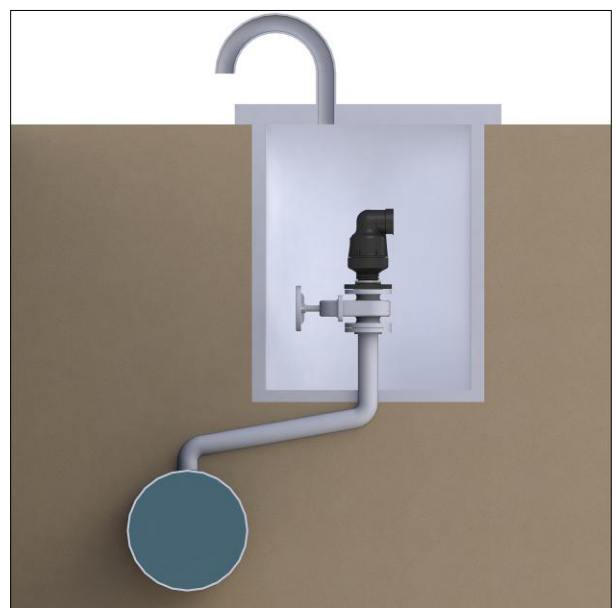
Dos válvulas de aire en una válvula de aislamiento compartida. Las salidas de la válvula de aire están orientadas hacia afuera, y las válvulas de aislamiento en un ángulo de 45° con respecto a las salidas de la válvula de aire
