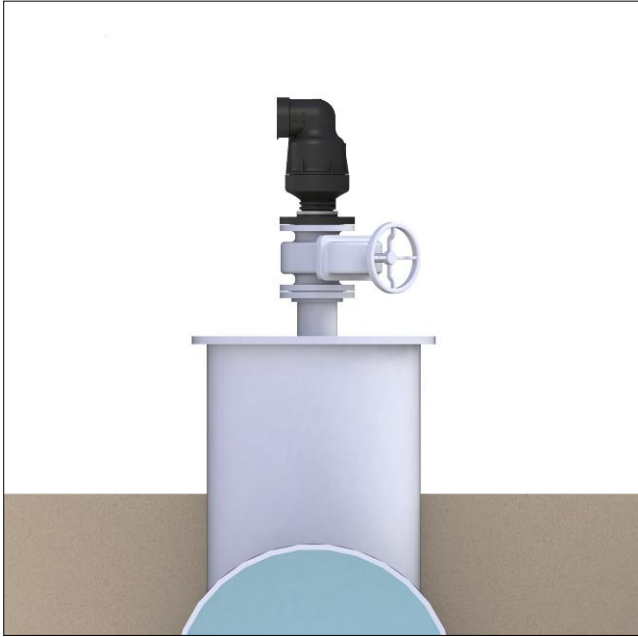
Válvula de aire única en una válvula de aislamiento situada a 45° respecto a la salida de la válvula de aire
