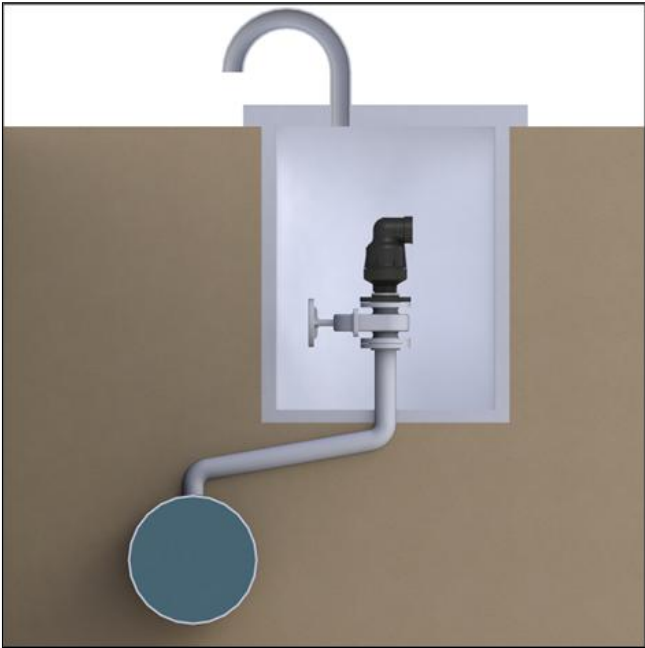
התקנות תת קרקעיות: • התקנות תת קרקעיות דורשות צינור אורור היוצא מהשוחה. התקנה זוויתית לעקיפת מכשול, יש לבצע ישירות מעל לצינור.
