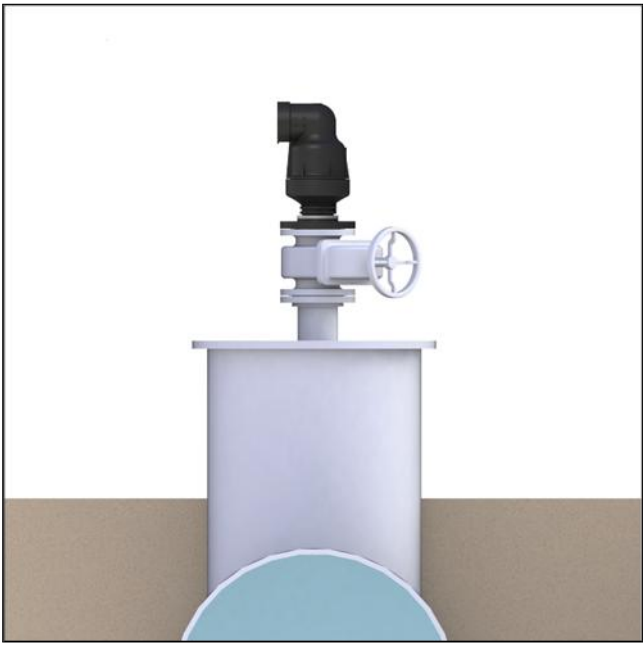
שסתום אוויר יחיד על גבי מגוף ניתוק: יש להתקין שסתום אוויר יחיד על גבי מגוף ניתוק, בזווית של 45° לפתח היציאה של שסתום האוויר.
