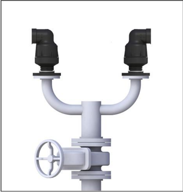
שני שסתומי אוויר על גבי מגוף ניתוק משותף: השסתומים יותקנו עם פתחי היציאה מופנים כלפי חוץ ומגוף הניתוק יימצא בזווית של 45° לפתח היציאה של שסתום האוויר.
