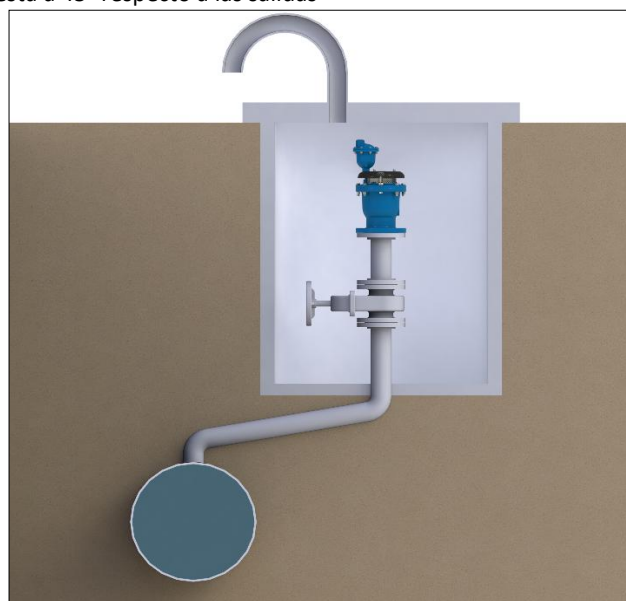
Dos válvulas de aire en una válvula de aislamiento compartida. Las salidas de las válvulas apuntan hacia fuera y la de aislamiento está a 45° respecto a las salidas
