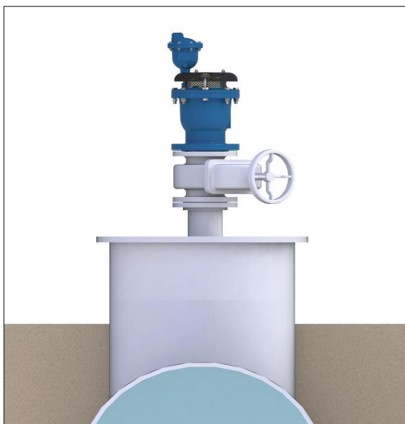
Válvula de aire única en una válvula de aislamiento situada a 45° respecto a la salida de la válvula de aire
