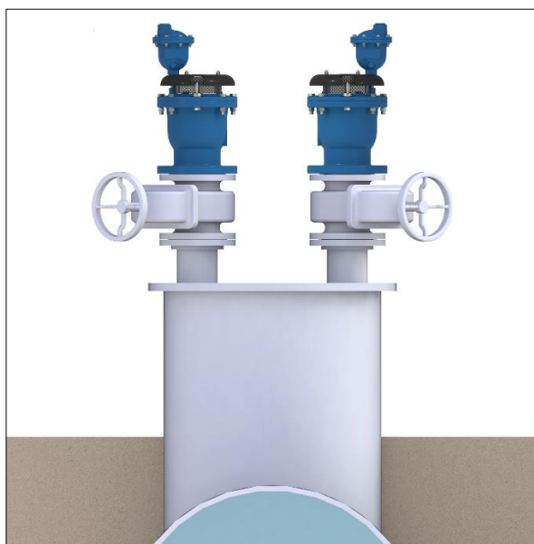
Dos válvulas de aire en una trampa de aire con válvulas de aislamiento separadas. Las salidas de las válvulas apuntan hacia fuera y las de aislamiento están a 45° respecto a las salidas
