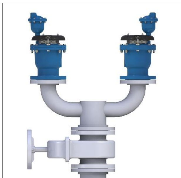
Dos válvulas de aire en una válvula de aislamiento compartida. Las salidas de las válvulas apuntan hacia fuera y la de aislamiento está a 45° respecto a las salidas
